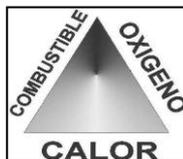
**Figura:** Los componentes de la combustión. Como observamos, además del combustible (sustancias que pueden combustionar) y el oxígeno, se necesita energía (calor).
